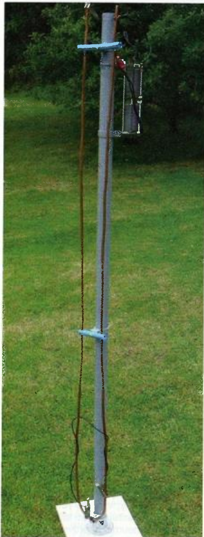
Obr. 9. Vertikální vyladěný dipól typu „Hairpin“. Název (v překladu „sponka do vlasů“) vyplývá z tvaru smyčky. Protože jde vlastně o hodně zúžený obdélník, je jeho vyzařovací charakteristika podobná běžné kruhové nebo obdélníkové MLA
