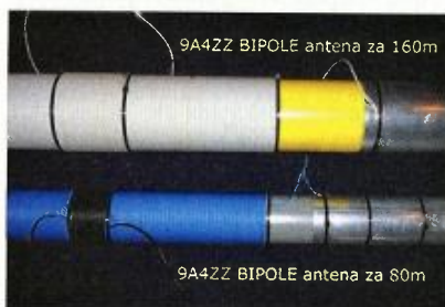
Obr. 5. Detail vazebního vinutí a kapacitního nastavce u vzorku pro pásmo 80 a 160 m
