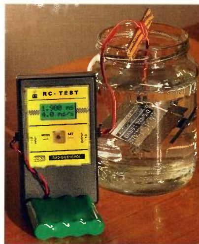
Obr. 17. Zkoušky těsného serva při ponoření pod hladinu
