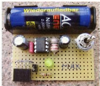
Obr. 5. Fotografia realizovaného meniča s MAX756
