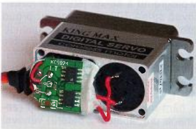
Obr. 16. Celokovový kryt serva King Max a současně vada servozesilovače - odizolované vodiče přivodů potenciometru zkratované proti napájení
