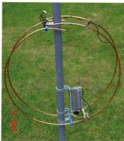
Obr. 10. Dipól typu „Hairpin“, stočený do smyčky. Anténa v tomto provedení má maximum vyzařování pouze v jednom směru (viz obr. 11)
