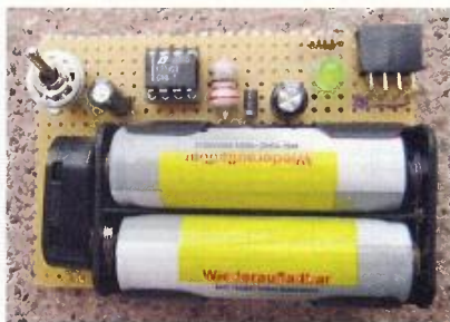
Obr. 2. Menič s LT1303-5 na univerzálnej doske
