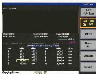
Obr. 5. Funkce pass/fail a omezující křivka zadaná tabulkou
